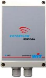
L'Extension GSM Cube permet à l'e@sy d'envoyer des alarmes par SMS, d'émettre et de recevoir des télécommandes de site à site, de transmettre ses données à un superviseur, etc.
