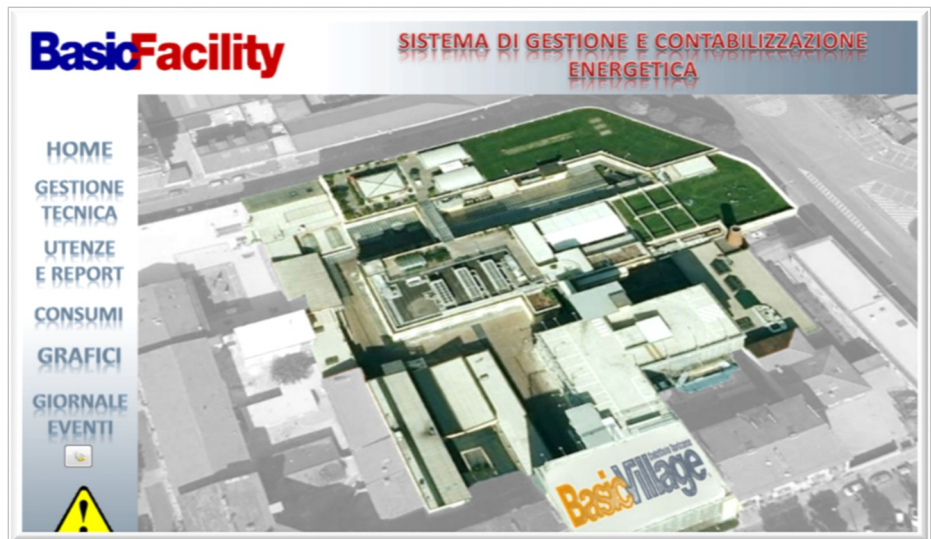
L'interface de supervision opérationnelle permet un pilotage en temps réel des installations, et le suivi des performances énergétiques
