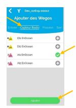
Dans l'onglet « **Paramètre** », renseigner le **numéro de série** et le **type de capteur** ou activer la fonction « **Apprentissage** »
