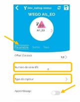
Après avoir activé la fonction « Apprentissage », forcer l'envoie d'une trame sur le capteur.
