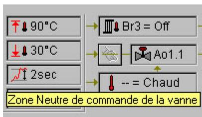
Figure 2.66 : Ressource Régulation vanne pas à pas - Zone neutre de commande de vanne
