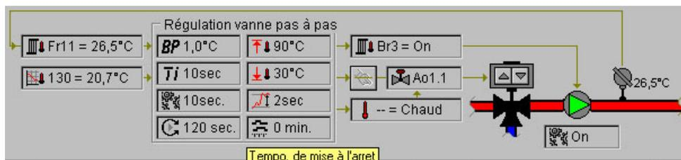
Figure 2.67 : Ressource Régulation vanne pas à pas - Temporisation de mise à l'arrêt
