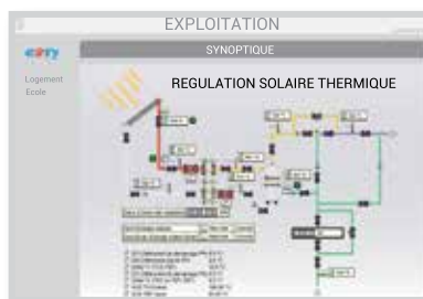
Représentation synoptique de votre installation (états de fonctionnement des équipements, visualisation des valeurs instantanées...)
