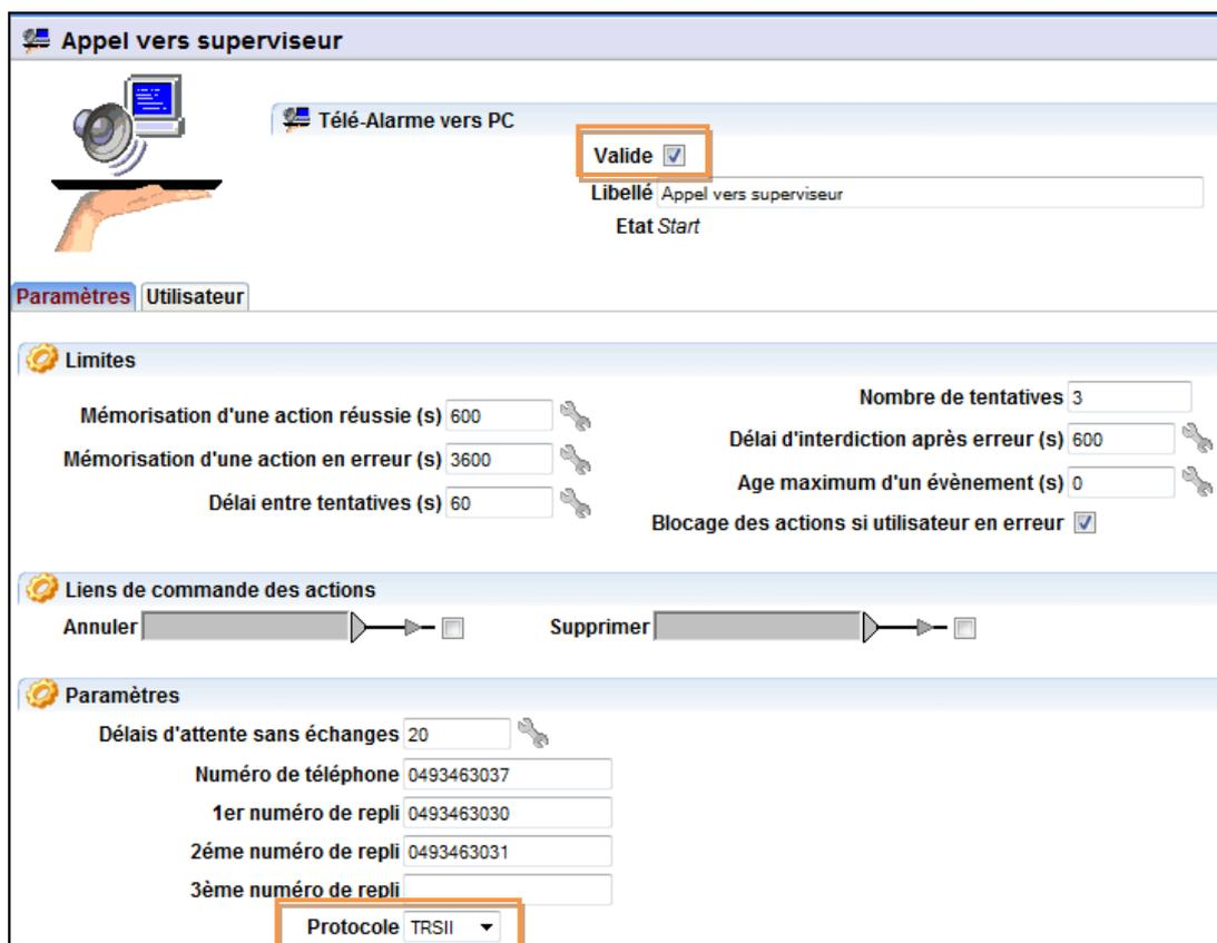
Après avoir donné un libellé à l'agent, dans l'onglet « Paramètres » on indique les numéros de téléphones que l'e@sy doit appeler pour transmettre ses alarmes. Il est possible de prévoir des numéros de repli (3). Lorsqu'un numéro ne répond pas on passe au 1er numéro de repli et ainsi de suite. Le protocole de communication (par défaut) est le **TRSII**.
